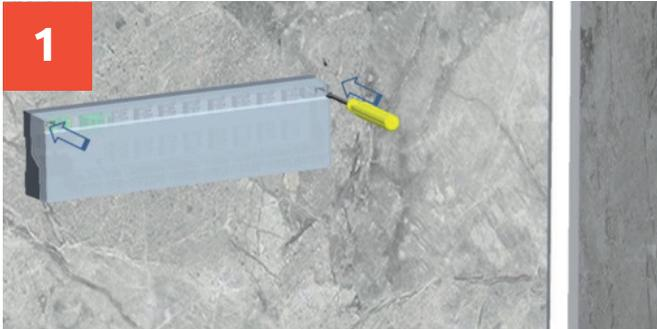
Utilice un destornillador para desclipar la cubierta de carcasa en los dos puntos de anclaje y sáquela.
