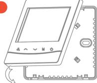
Enganche la parte frontal del termostato sobre la placa posterior.
